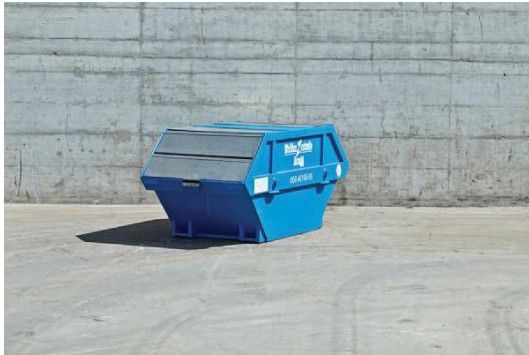
6 m 3 — Mulde (gedeckt, abschliessbar) L = 3.50 m, B = 1.65 m, H = 1.55 m Geeignet für leichtes, brennbares Material
